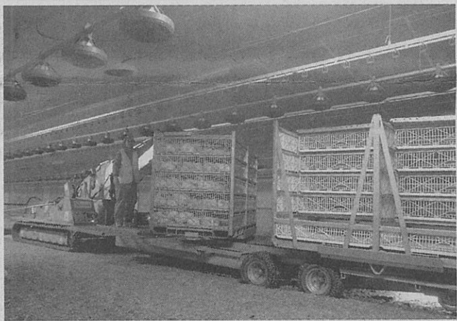
海外では上のような専用リフトで鶏舎に搬入している農場も
